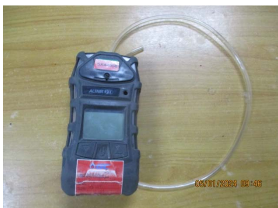
รูปที่ 52 Combustible Gas Detector
